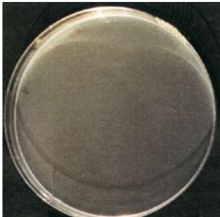
Prøve af trykluft taget fra en oliefri kompressor med adsorptionstørrer. Efter dyrkning af prøven var man ikke i stand til at konstatere nogen form for bakterier i denne.
