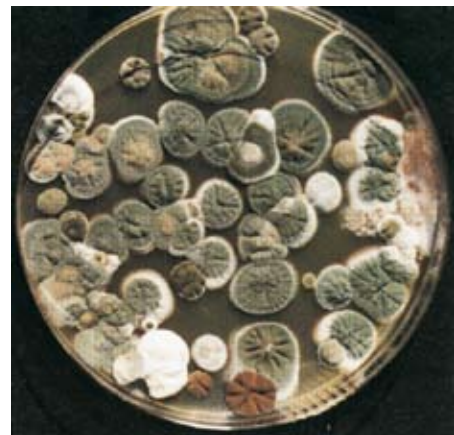
Prøve af trykluft taget fra en oliesmurt kompressor, hvor der ikke er foretaget nogen form for tørring af trykluft. Efter dyrkning af prøven konstateres en stor koncentration af forskellige former for bakterier.
